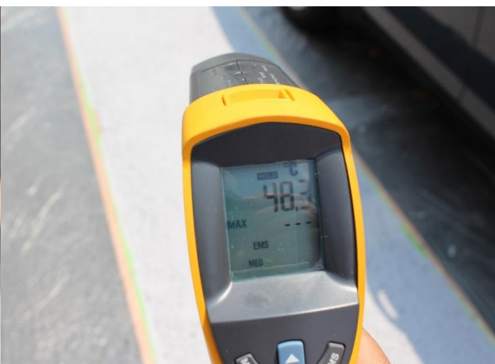
敷地内駐車場 施工後 48.3°C
